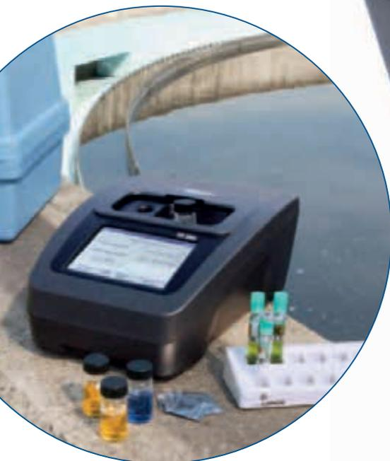
Utilizzo in campo: DR 2800 è robusto, impermeabile e con la batteria ricaricabile gode di 40 ore di autonomia: l'ideale per le analisi in campo e come laboratorio portatile
