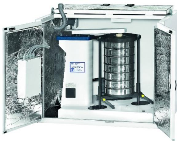
L'agitatore Ro-Tap® RX 29 CE è compatibile con setacci di diametro fino a 203 mm.
