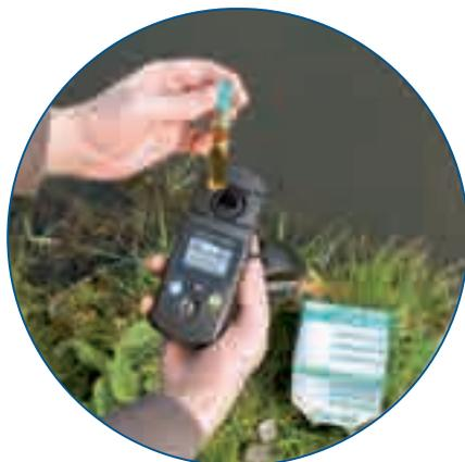
Durante il tempo di reazione, si procede con l'azzeramento del POCKET utilizzando le cuvette del bianco in dotazione. Semplicemente premendo un pulsante, il POCKET sarà pronto per misurare la cuvetta campione.
