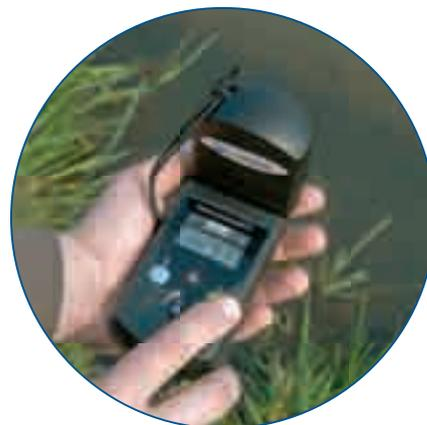
Una volta posizionato il cappuccio di protezione dalla luce, la misurazione può iniziare. Basterà premere il pulsante per ottenere i dati richiesti, visualizzati sull'ampio display.
