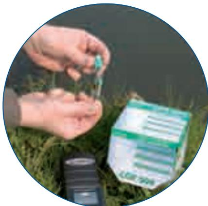
Sul campo: i campioni vengono aggiunti direttamente nel Test in Cuvetta LANGE. La cuvetta è pronta per la lettura in pochi minuti.
