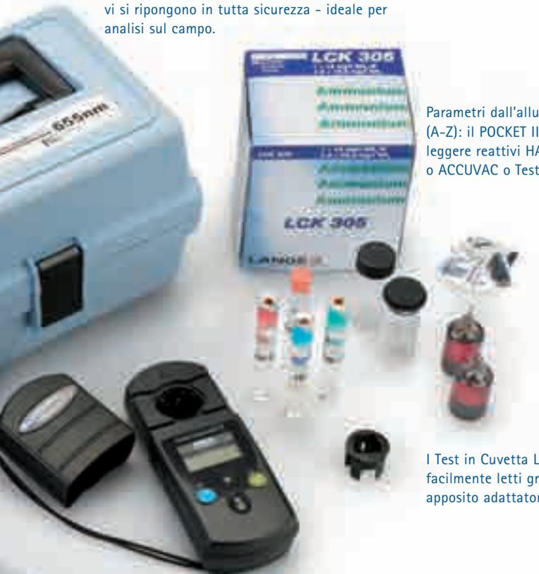
Parametri dall'alluminio allo zinco (A-Z): il POCKET II è in grado di leggere reattivi HACH PERMACHEM o ACCUVAC o Test in Cuvetta LANGE.
