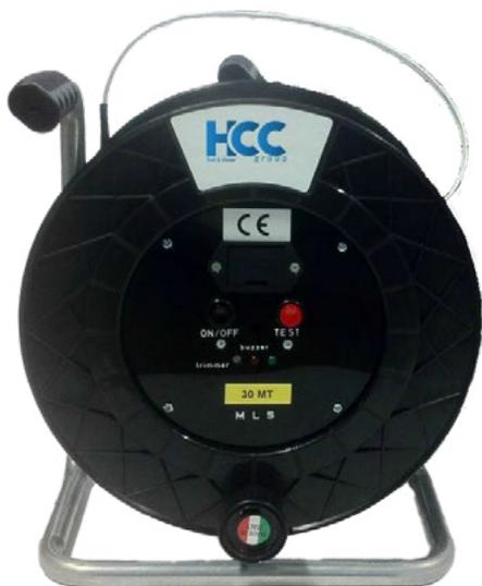
Strumento portatile per la misura del livello in pozzi e piezometri, montato su rullo avvolgicavo nel cui interno è alloggiata una scheda elettronica per il condizionamento del segnale sia acustico che luminoso.
